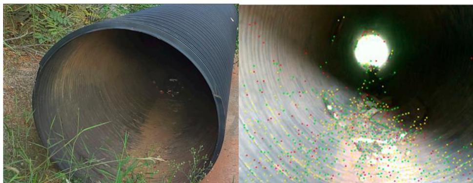
Рис. 2. БПЛА залетает в трубу и производит съемку [7]
